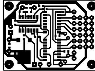
Синтезатор тактовой частоты.
